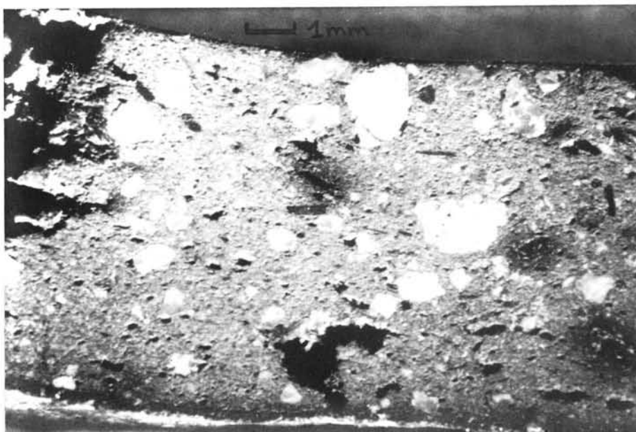
FIGURA 3: Fotografía de una sección pulida de una cerámica gris. Los granos de desgrasante son mayoritariamente cuarzo. Las zonas oscuras situadas alrededor de algunos poros corresponden a zonas donde se ha provocado una reducción local más acusada a causa de la combustión deficitaria en oxígeno de la materia orgánica que contenía el poro.
