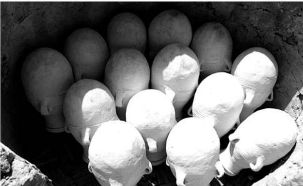
Fig. 6c : Jarres filaliennes. Atelier de Glagla et d'el-Mrakna (Tâfilâlet) : Le défournement.
