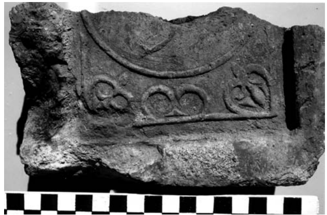
Fig. 3 : La superficie decorata di un mattone "impresso" o "stampigliato". Firenze, Laboratorio di Diagnostica per il Restauro dei materiali - Dipartimento di Storia dell'Architettura e Restauro delle Strutture Architettoniche.
