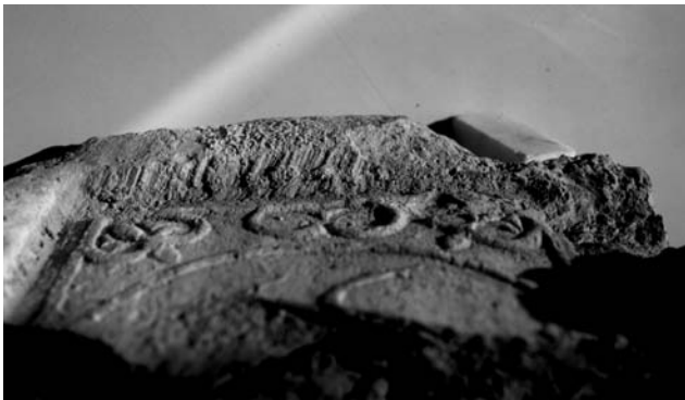
Fig. 4 : Particolare delle striature lasciate dal movimento del tampone nell'impasto fresco. Firenze, Laboratorio di Diagnostica per il Restauro dei materiali - Dipartimento di Storia dell'Architettura e Restauro delle Strutture Architettoniche.
